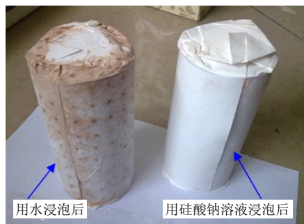
图9 用水和硅酸钠溶液浸泡后的重塑样
